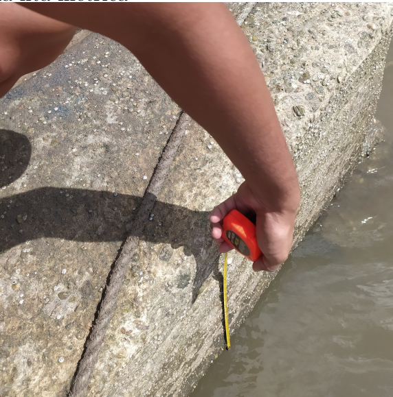
Figura 5.3: Coletando a altura com o auxílio da fita métrica
