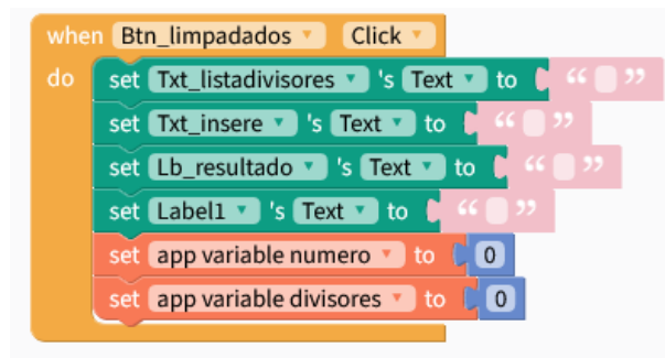
Figura 35 – Limpando os conteúdos dos componentes e zerando as variáveis
