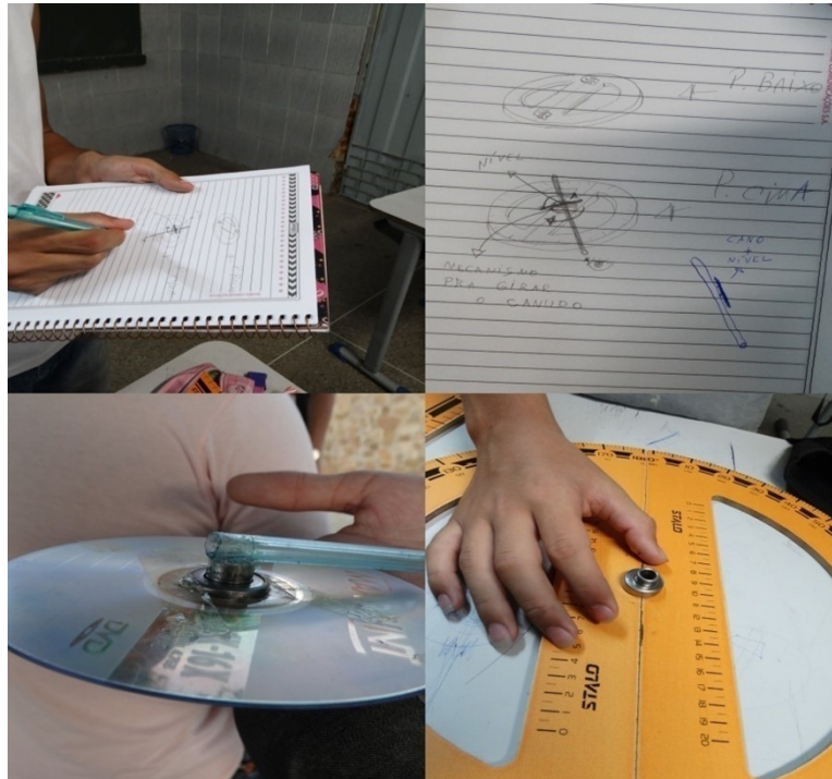
Figura 5.10: Ideia inicial para o teodolito horizontal.
