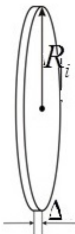
Figura 4.7: Cilindro obtido do giro de um retângulo em torno do eixo x
