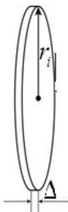
Figura 4.5: Cilindro obtido do giro de um retângulo em torno do eixo x
