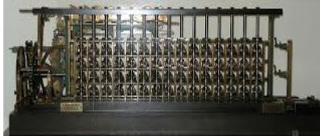
Figura 2.21: Difference Engine de Scheutz. (Fonte: [16].)
