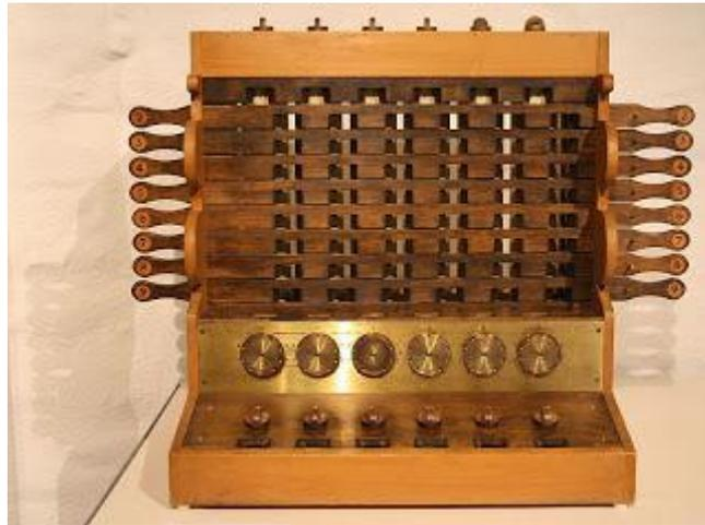
Figura 2.14: Calculadora de Wilhelm Schickard. (Fonte: [16].)
