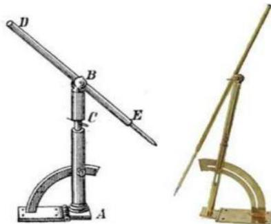
Figura 6. Conicógrafo de Barocius
