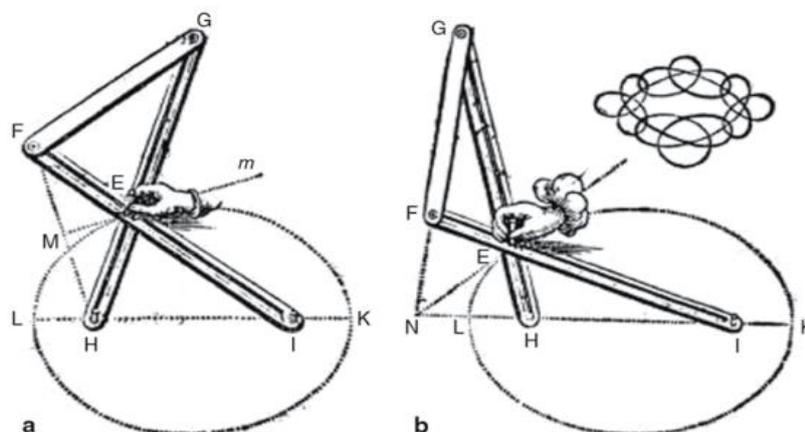
Figura 26. Traçador a elipse utilizando ao antiparalelogramo.
