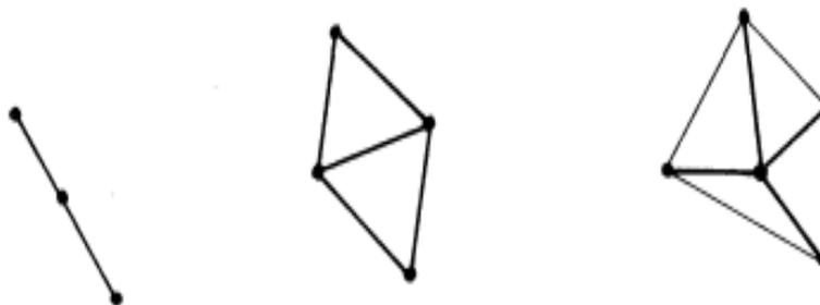
Figura 18. Exemplos de estruturas não rígidas.
