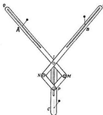
Figura 4. Aparelho de Leonardo para resolver o problema de Alhazen
