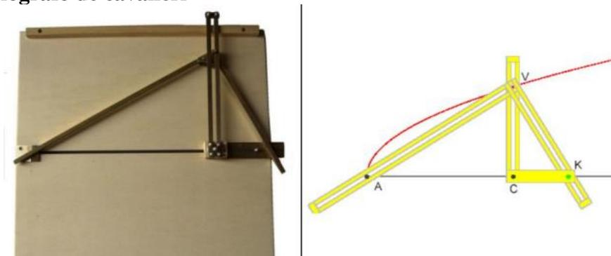
Figura 24. Parabológrafo de Cavalieri.
