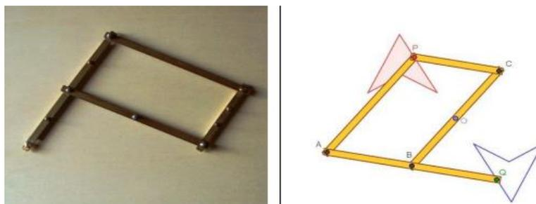
Figura 22. Pantógrafo de simetria central.
