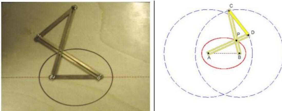
Figura 27: Traçador a elipse utilizando ao antiparalelogramo.
