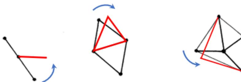
Figura 19. Ilustração de movimentos que preservam o comprimento das hastes.
