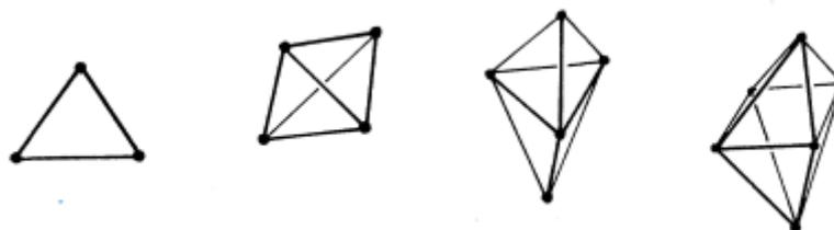
Figura 17. Exemplos de estruturas rígidas.
