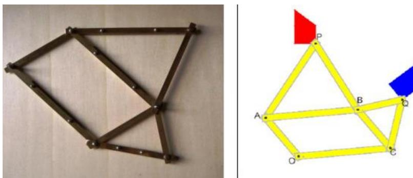
Figura 23. Pantógrafo de rotação.
