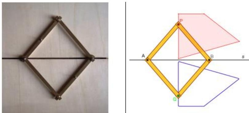
Figura 21. Pantógrafo de simetria axial.
