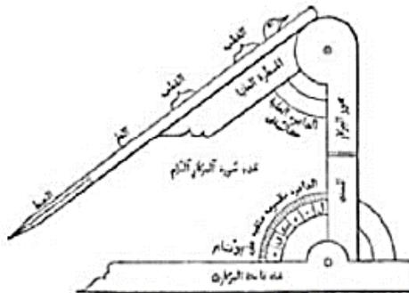
Figura 2. Reprodução do conicógrafo (construtor de cônicas)
