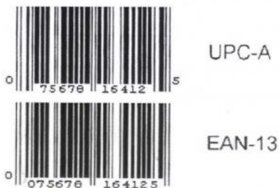
Figura 45 – Apêndice A – Diferenciação de código de barras: UPC-A e EAN-13
