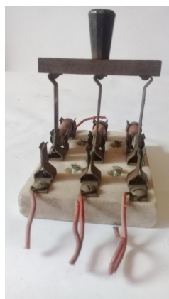
Figura 15 – Chave de Acionamento Elétrico Manual Antiga
