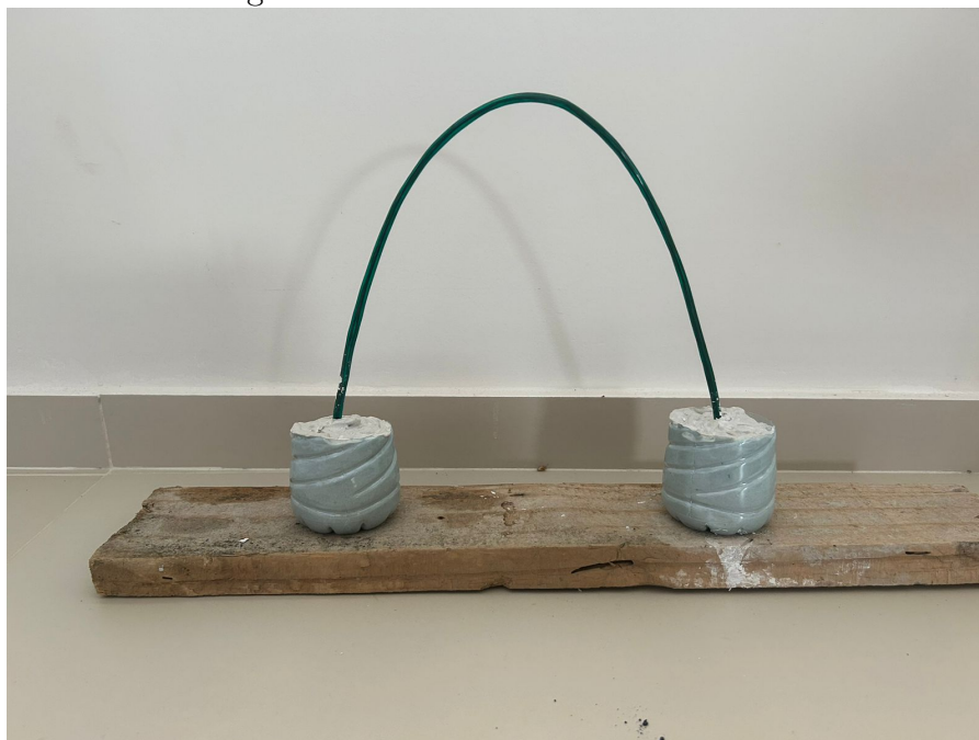
Figura 79: Arco catenário construído
