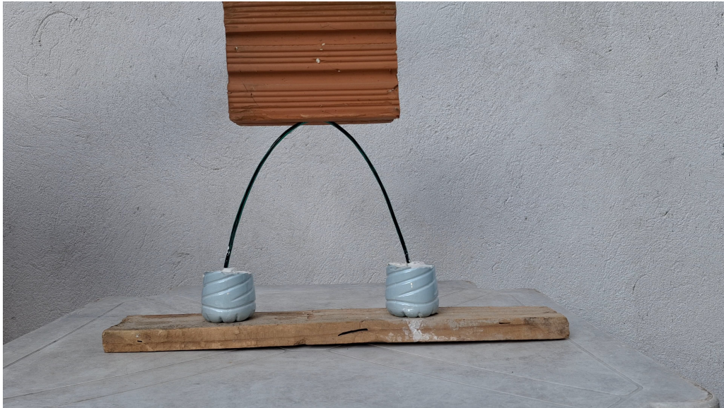
Figura 84: Posicionando o Peso no Arco Catenário
