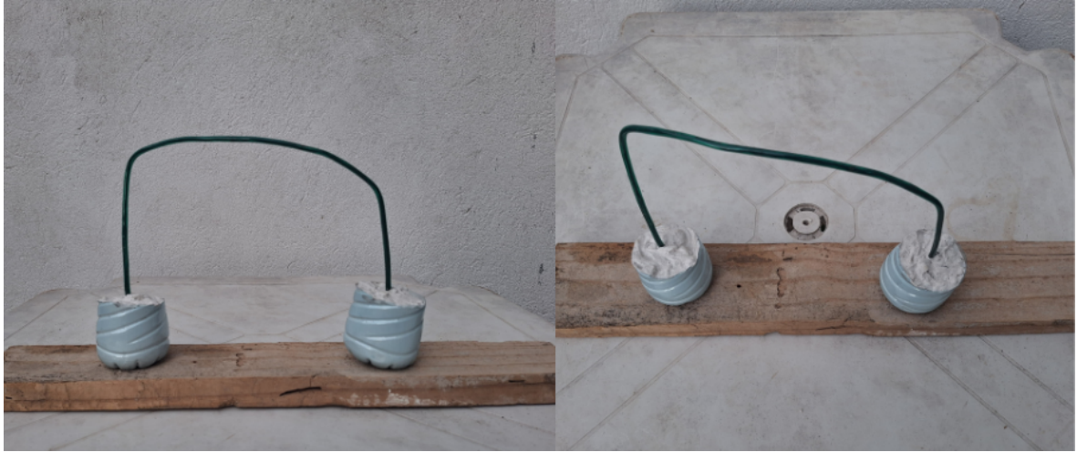
Figura 86: Arco Catenário Deformado
