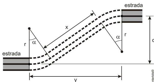
Se o engenheiro adotar  $\alpha = 45^\circ$ , o segmento central medirá  $x = d\sqrt{2} - 2r(\sqrt{2} - 1)$ . Nesse caso, supondo que  $d = 72$  m e  $r = 36$  m, determine a distância  $y$  entre as extremidades dos trechos a serem interligados, com precisão de 1 cm.
