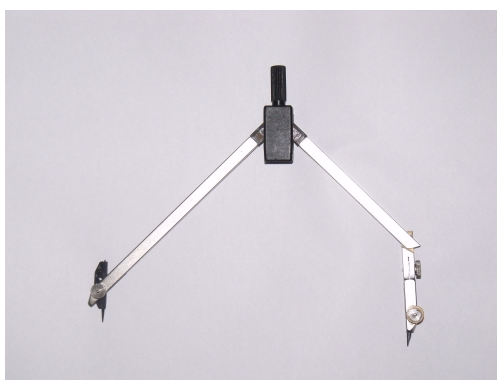
Figura 3.3: Compasso profissional para desenho técnico observado para adaptações ao compasso de madeira.
