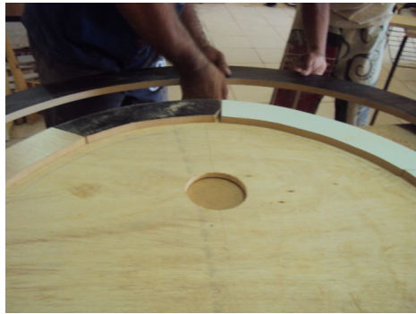
(e) Colagem do alteamento
