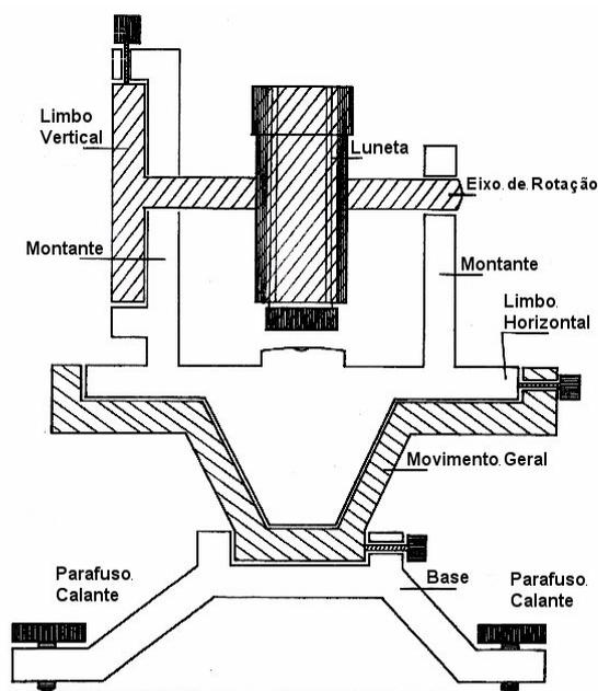
Figura 33 – Estrutura de um teodolito
