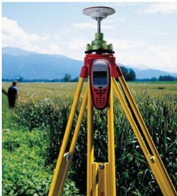
Figura 23 – Receptor de sinais do GPS
