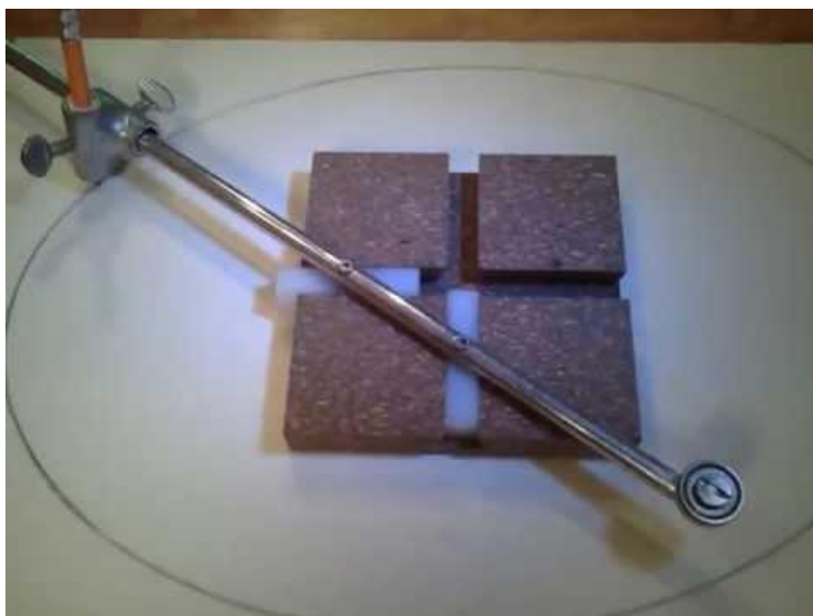
Figura 23 - Funcionamento do Elipsógrafo de Proclo
