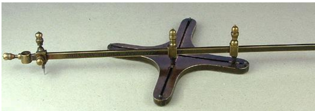
Figura 28 - Elipsógrafo de Proclo
