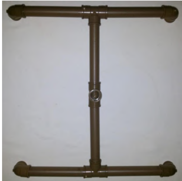
Figura 2.8: Parte central da perna para base de lançamento dos foguetes.
