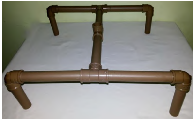
Figura 2.9: Parte central da perna para base de lançamento dos foguetes.
