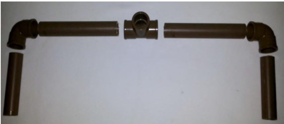
Figura 2.5: Perna da base de lançamento dos foguetes.
