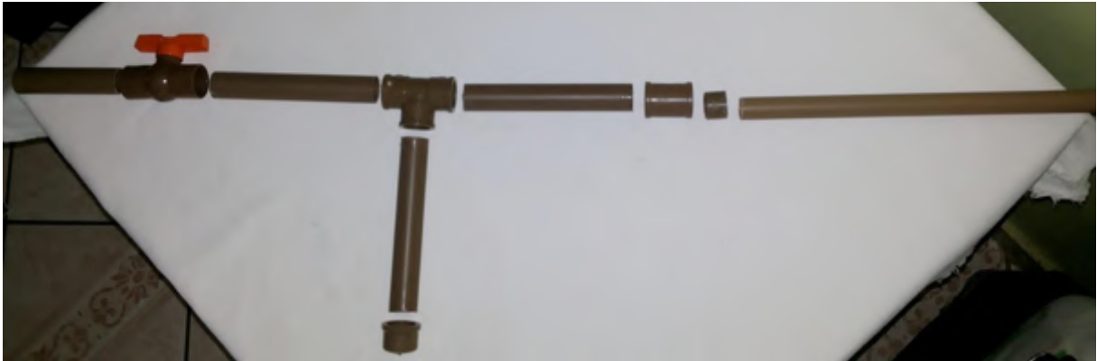
Figura 2.10: Montagem do sistema de propulsão para o lançamento de foguetes.
