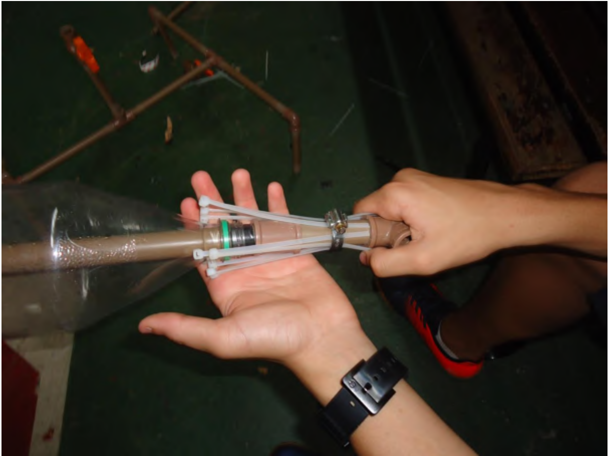
Figura 2.12: Montagem do sistema de retenção do foguete na base.
