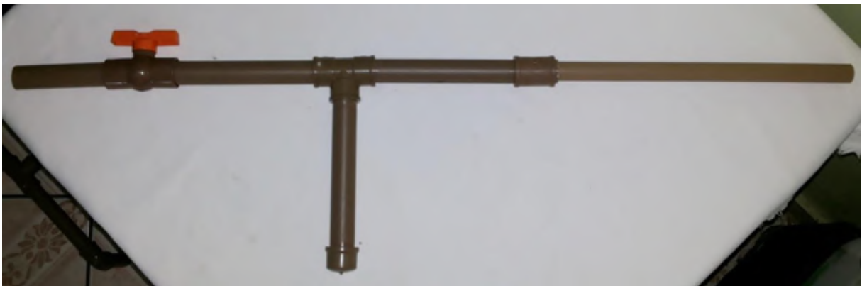
Figura 2.11: Montagem do sistema de propulsão para o lançamento de foguetes.
