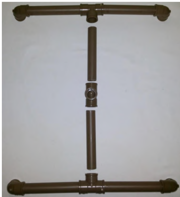
Figura 2.7: Parte central da perna para base de lançamento dos foguetes.
