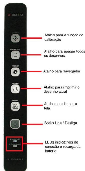
Figura 5 - Botões de atalho do receptor Station e LED indicadores
