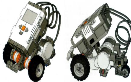
A vantagem de se utilizar esse formato está na sua grande eficiência, pois com apenas dois servomotores é possível controlar a direção e o sentido do deslocamento, obtendo-se os movimentos desejados a partir da utilização de uma estrutura simples.
