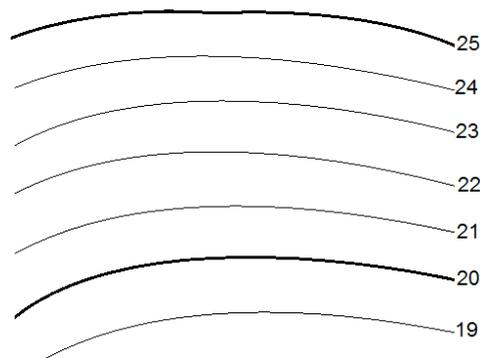
Figura 5.13: Terreno em curva com inclinação uniforme.
